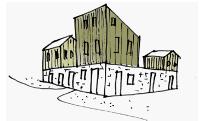
Binnenblok metselwerk plint met houten woningen erboven
